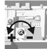
Чтобы приблизить луч к двери поверните винт по часовой стрелке, чтобы удалить от двери - против часовой стрелки
