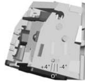
Метки показывают угол наклона
