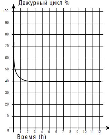
Кривая интенсивности: интенсивность выражается в процентах эффективного рабочего времени (открывание + закрывание к общему времени цикла (открывание + закрывание + пауза)).
