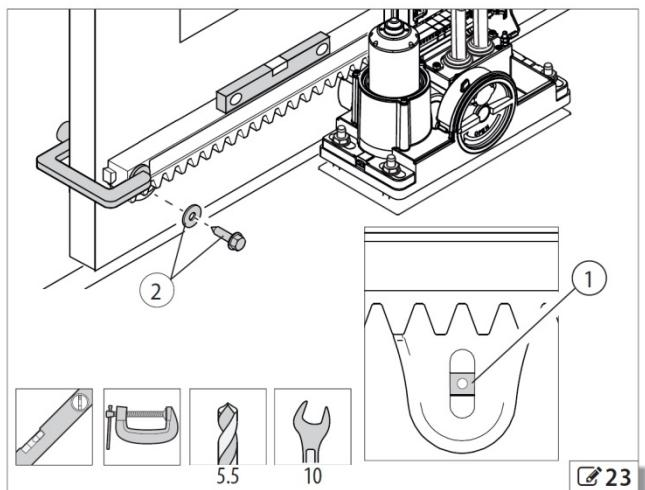
Используйте крепежные винты, предназначенные для материала, из которого изготовлена створка. Саморезы и шайбы в ассортименте FAAC доступны для алюминия или стали и заказываются отдельно ( 20-2).
