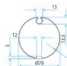
TM2 58 Адаптер для круглой трубы с пазом 78 мм
