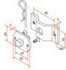
TM2 35 Опора с квадратным хвостовиком и омегаобразной скобой
