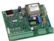
Электронная плата 578D (удалённая установка)
