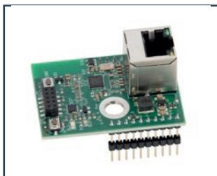
*XMULTICOM, оборудованный устройством XWBL или XMBX, позволяет управлять совместимой автоматикой, оснащенной XRS485, а также другой общей автоматикой (например, включение света, системы полива и т.п.)*
