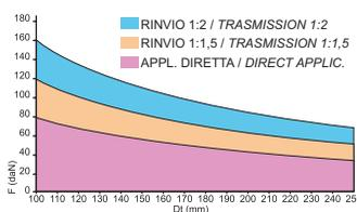
Для оценки правильности выбора системы автоматики измерьте усилие, необходимое для подъёма ворот (значение должно быть указано в документации на ворота) и диаметр намоточного барабана троса. График позволяет определить возможность применения мотор-редуктора и необходимость использования передаточного механизма со смещенной осью тяги. (см. принадлежности).
