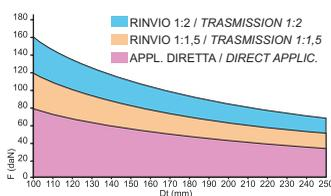
На графике показано, в каких приложениях можно использовать 541 ЗРН с учётом максимально необходимого усилия для ручного перемещения ворот F в деканьютонках (даН) (1 даН — усилие, необходимое для подъёма 1,02 кг груза) и диаметра барабана для намотки троса, выраженного в миллиметрах. Например, имеются ворота, которые могут перемещаться под действием силы 108 даН и барабан с диаметром 180 мм. Следует использовать 541 ЗРН с цепным приводом и передаточным отношением 1:1,5.
