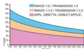
Для оценки правильности выбора системы автоматики измерьте усилие, необходимое для подъёма ворот (значение должно быть указано в документации на ворота) и диаметр намоточного барабана троса. График позволяет определить возможность применения мотор-редуктора и необходимость использования передаточного механизма со смещённой осью тяги. (см. принадлежности).
